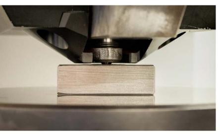
*Figure 2. Close-up of a calibration-grade Brinell tester Figura 2. Probador de Brinell, grado calibrador, en primer plano*
